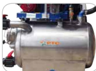
Cisterna in acciaio inox con valvola di sovrappressione e collettore troppo pieno.
